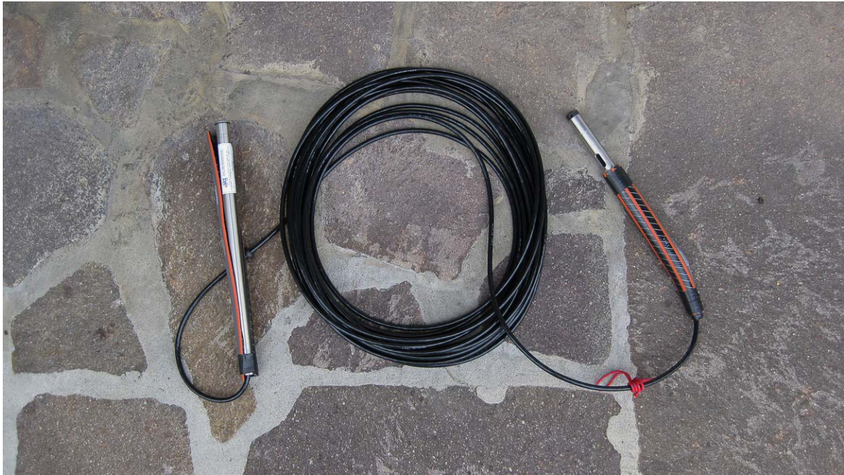
Figura 1 - Sonda CTD della ditta OTT, avente numero seriale 363897, impiegata nell'applicazione del metodo della diluizione salina a bilancio di massa.
