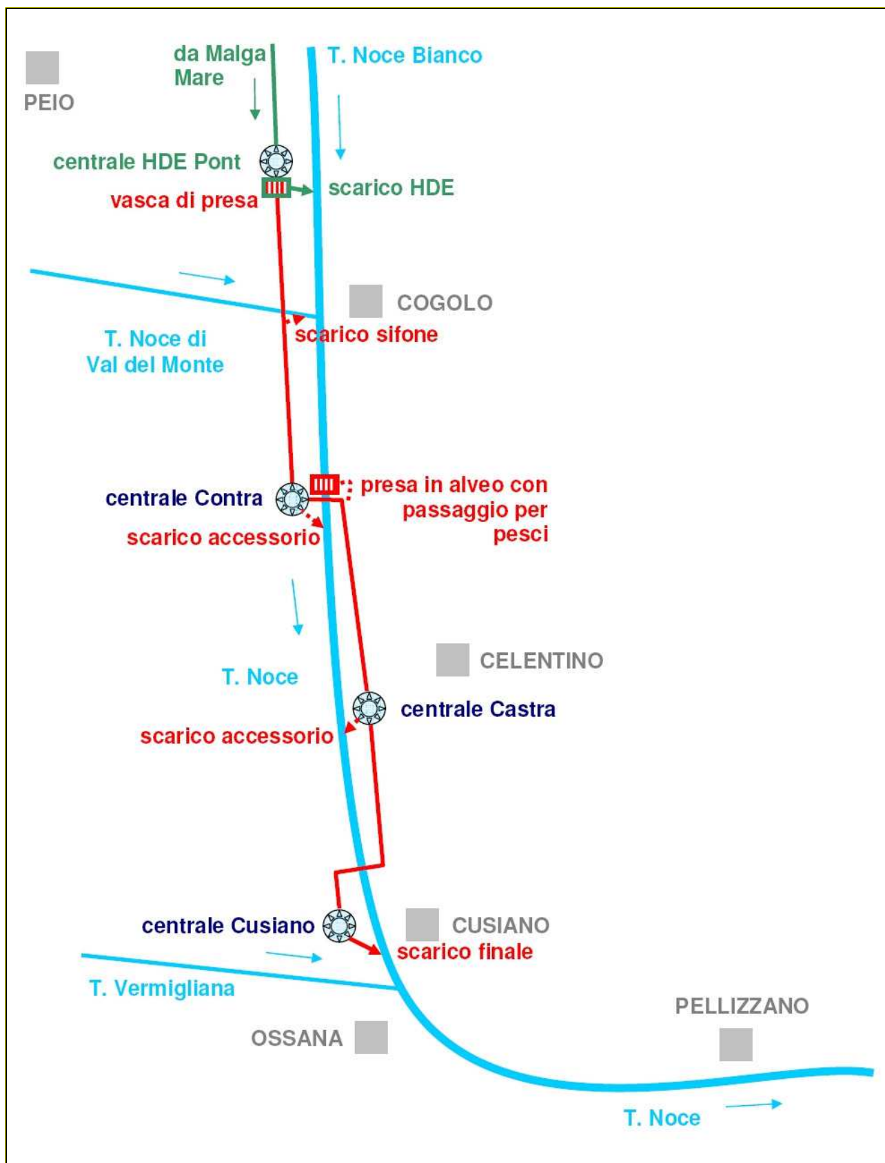
Figura 1 - Schema planimetrico del nuovo sistema degli impianti idroelettrici di Contra, Castra e Cusiano e dei suoi rapporti con l'impianto esistente e soprastante di Cogolo Pont (HDE) e con il corso d'acqua.
