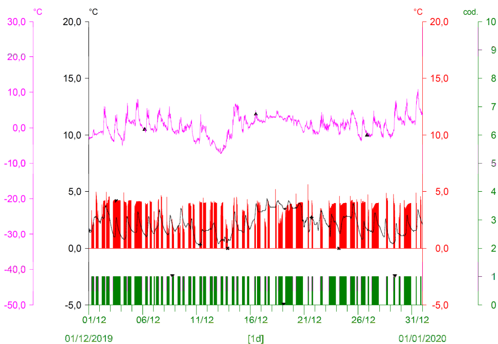
Fig. 114 - Termogrammi comparati C0 vs S1 del mese di DICEMBRE 2019. Le temperature atmosferiche si mantengono attorno a pochi gradi sopra lo 0°C per tutto il mese, senza peraltro che le acque in alveo subiscano fenomeni di congelamento.
