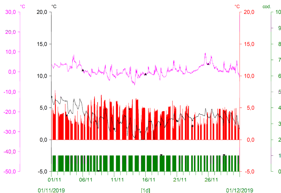
Fig. 113 - Termogrammi comparati C0 vs S1 del mese di NOVEMBRE 2019. Dalla seconda settimana, con la fine lavori al L. di P. Palù, si completa l'inversione termica. Le acque in alveo, tra l'altro, si raffreddano velocemente durante il periodo di intense precipitazioni nevose, arrivando anche ai primi due giorni di congelamento anticipato dell'alveo (15-17.11.2019).
