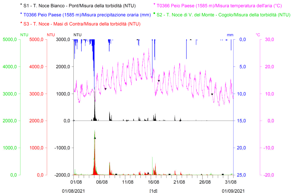
Fig. 133 - Turbidigrammi comparati S1 vs S2 vs S3 del mese di AGOSTO 2021. A differenza dell'anno precedente si notano solo 10 eventi di bassa intensità misurati nel T. Noce Bianco, e dovuti a pulizia dei canali Dufour, a cui aggiungere 3 eventi più intensi di origine temporalesca misurati invece su entrambi i rami del T. Noce.
