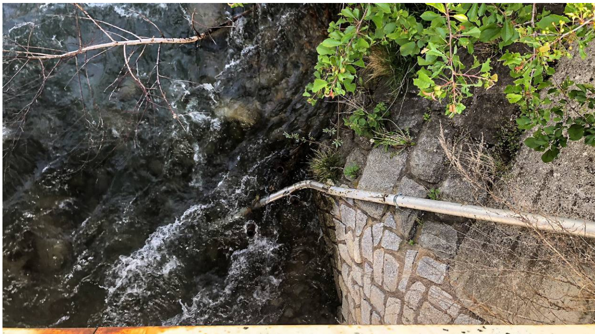
Fig. 26 - Infrastrutturazione della stazione di rilevamento S5 in data 27.05.2022 durante un intervento di manutenzione e controllo ordinario. Il tubo protettivo è sollevato rispetto al fondo dell'alveo e inclinato nel senso della corrente, evitando così il blocco di materiali fluitati dalla corrente.
