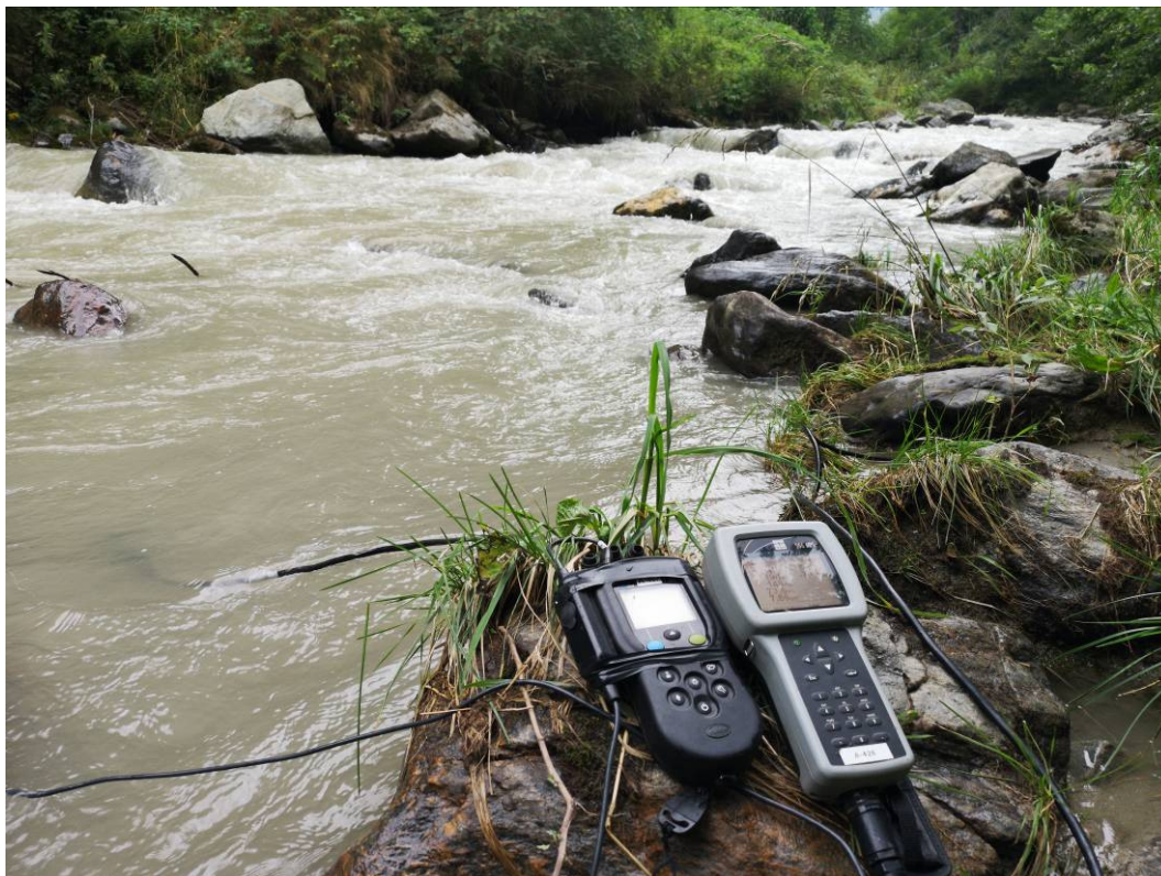
Fig. 13 - Rilievi in situ con sonde multiple ai fini del controllo della qualità chimica e fisica di base dell'acqua fluente - stazione N4.
