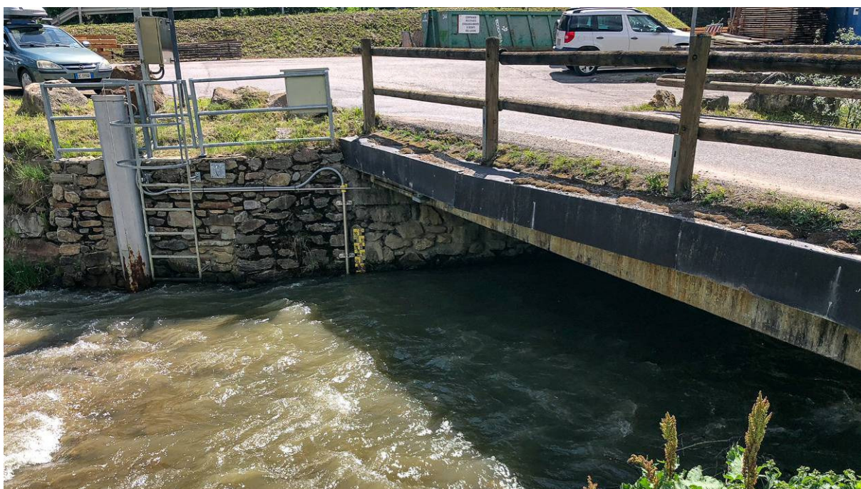
Fig. 23 - Infrastrutturazione della stazione di rilevamento S2 in data 27.05.2022 durante un intervento di manutenzione e controllo ordinario, con assetto definitivo dopo l'installazione della sonda Solitax all'interno del tubo protettivo (a sinistra), la ricollocazione dell'asta idrometrica e della sonda di livello e temperatura in corrispondenza del radar (al centro) sotto l'impalcato del ponte.
