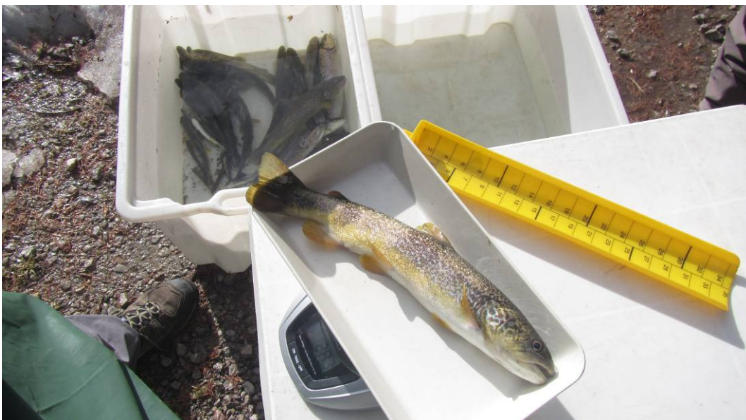
Fig. 70 - Rilievo dei caratteri biometrici essenziali degli esemplari di fauna ittica componenti i campioni prelevati con pesca elettrica (staz. N4 - Forno di Novale - 20.02.2020).
