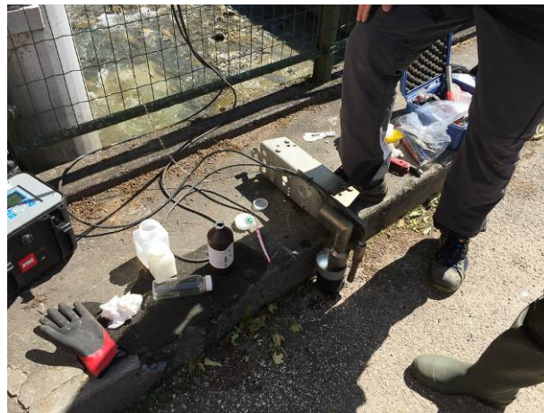
Fig. 2 - Manutenzione straordinaria della stazione S1 - Pont, eseguita in data 24.06.2020: 1) estrazione del carrello porta sonde dal tubo protettivo mediante catena, 2) immersione del turbidimetro nel liquido di controllo a torbidità nota per la verifica della corretta taratura.
