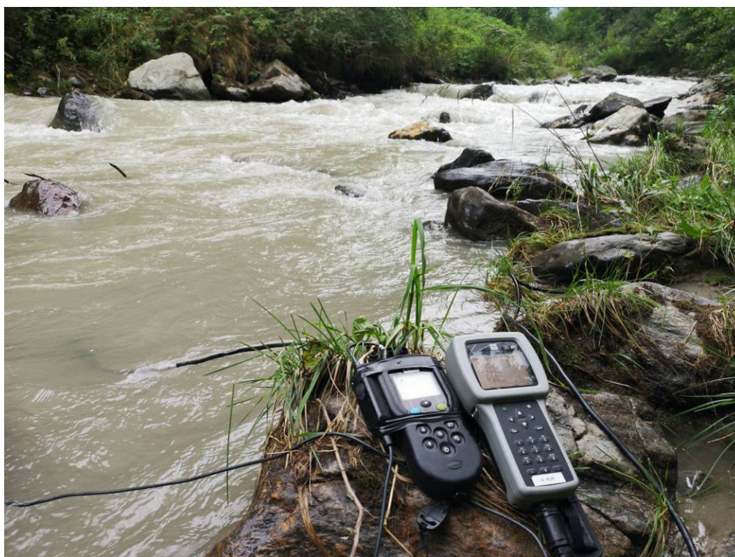
Fig. 18 - Rilievi in situ con sonde multiple ai fini del controllo della qualità chimica e fisica di base dell'acqua fluente - stazione N4 - 12.08.2019.
