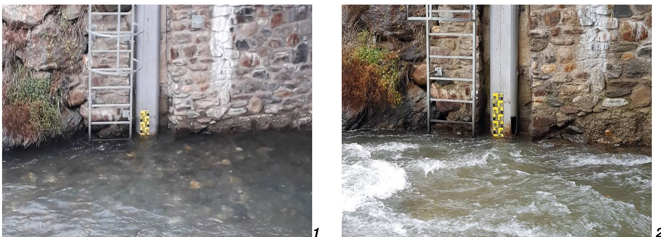
Fig. 4 - Manutenzione straordinaria della sezione S3 - Contra, eseguita in data 29.10.2019, dopo la rimozione in data 22.10.2019 dei sedimenti dalla canaletta di magra che impedivano l'asportazione del carrello porta sonde. A parità di fase idrologica nella seconda metà di ottobre il livello scende di circa 20 cm: 1) livello a circa 57 cm prima dell'asportazione dei sedimenti, 2) livello a circa 37 cm dopo l'asportazione dei sedimenti e la pulizia interna del tubo mediante apertura di una finestra sul lato di monte.
