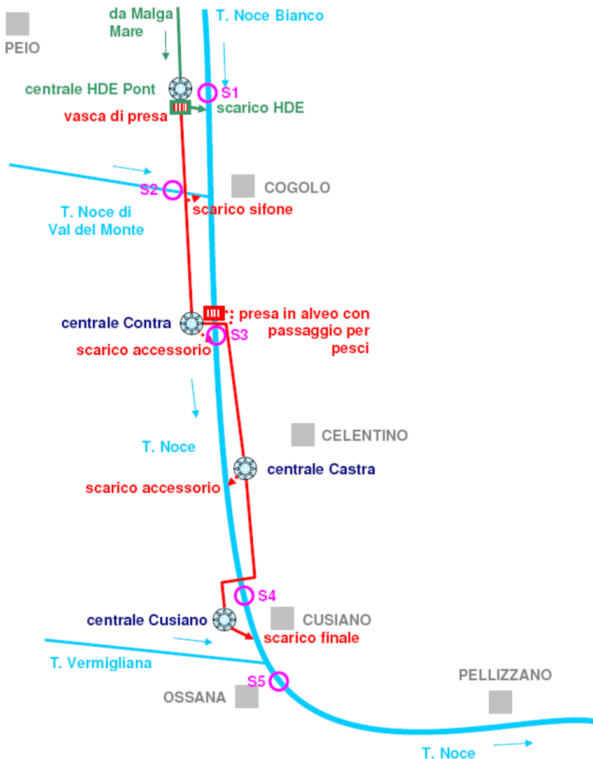
Fig. 27 - Analisi della idrometria, termometria e turbidimetria ai fini del monitoraggio ambientale: schema della localizzazione delle stazioni di rilevamento infrastrutturate in alveo "S".
