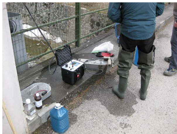
Fig. 1 - Manutenzione straordinaria della stazione S1 - Pont, eseguita in data 13.03.2019: 1) pulizia della sonda di torbidità montata su carrello, 2) tester per la ritaratura del turbidimetro mediante immersione in liquido di controllo a torbidità nota.
