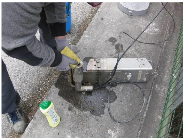
Fig. 1 - Manutenzione straordinaria della stazione S1 - Pont, eseguita in data 13.03.2019: 1) pulizia della sonda di torbidità montata su carrello, 2) tester per la ritaratura del turbidimetro mediante immersione in liquido di controllo a torbidità nota.
