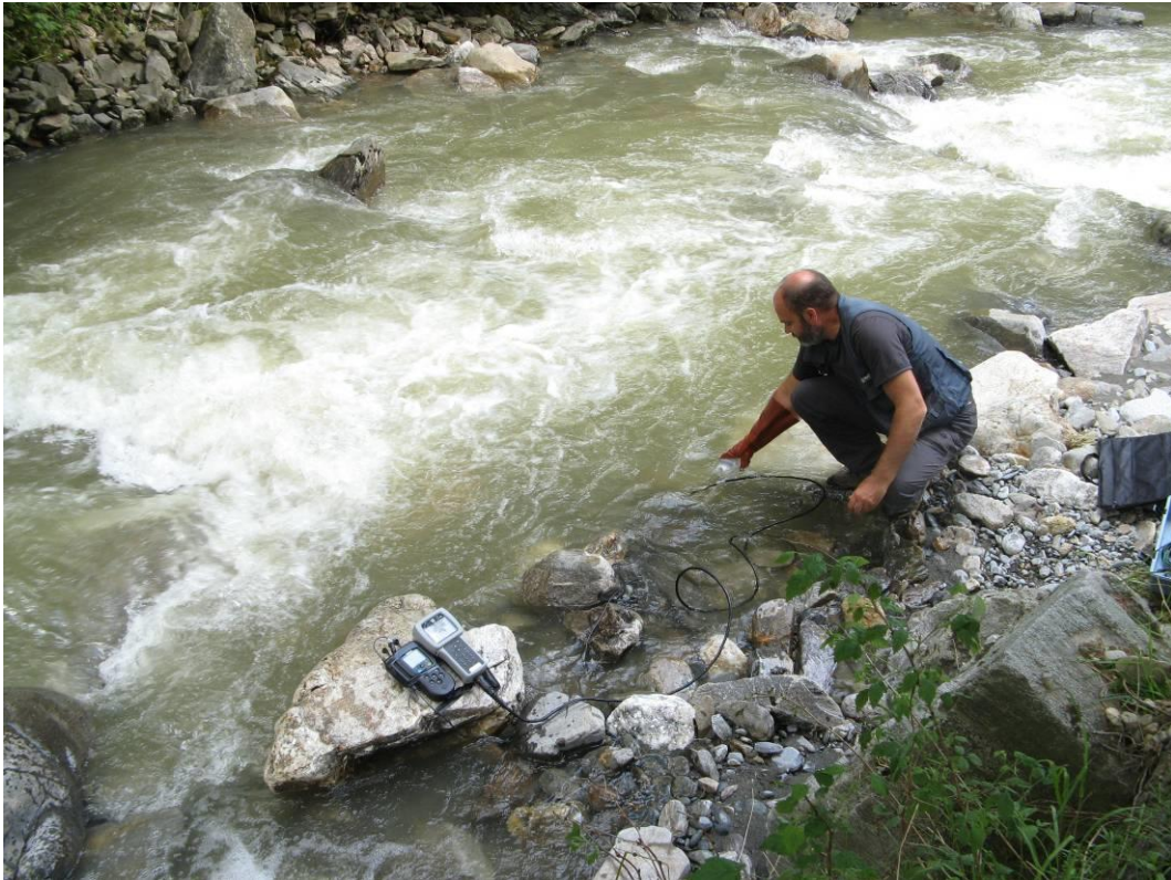
Fig. 15 - Raccolta di campioni d'acqua superficiale ai fini delle analisi di laboratorio sulla qualità chimica e microbiologica di base - stazione N1 - 17.06.2019.
