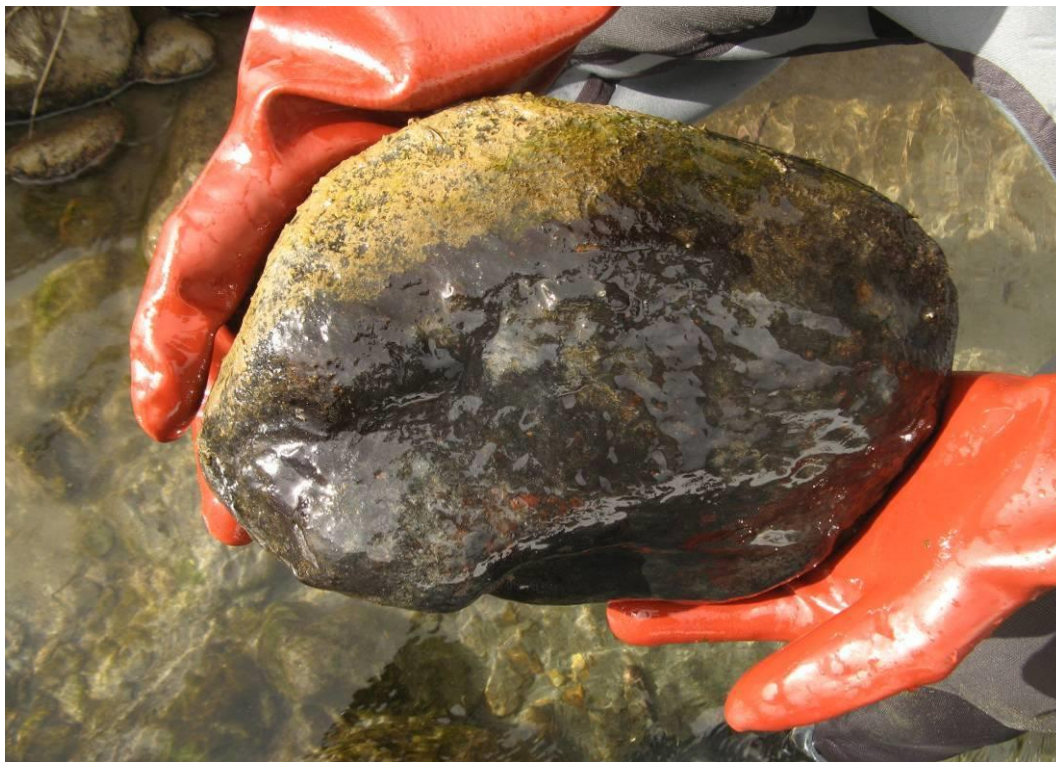
Fig. 39 - Evidenza di segni di anossia (fanghi scuri ad alto contenuto organico con segni di decomposizione anaerobica) sulla faccia inferiore di un masso sommerso nell'alveo del T. Noce a valle della confluenza della fognatura mista di Celledizzo (staz. N3 - 12.02.2018).
