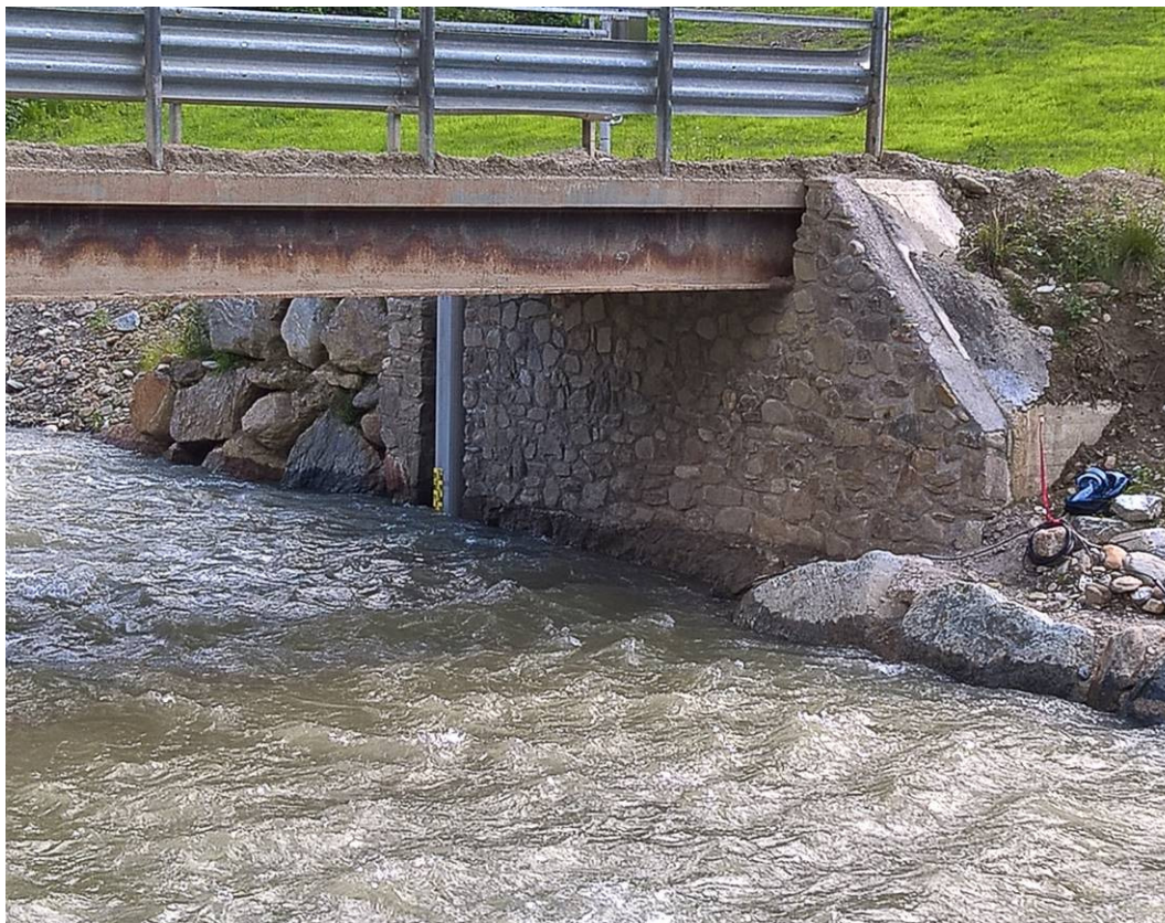
Fig. 26 - Infrastrutturazione della stazione di rilevamento S3 in data 27.06.2016 durante una misurazione delle portate con metodo della diluizione salina.
