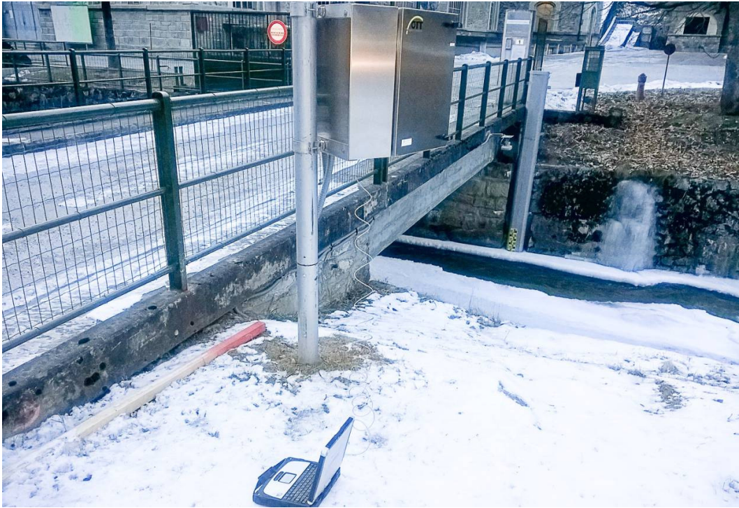
Fig. 24 - Infrastrutturazione della stazione di rilevamento S1 in data 19.01.2016 durante una fase di verifica della strumentazione da parte della ditta Corr-Tek Idrometria dopo l'avvio delle registrazioni. Si noti il mantenimento del deflusso in una sezione ristretta della canaletta di magra nonostante il congelamento delle sponde.
