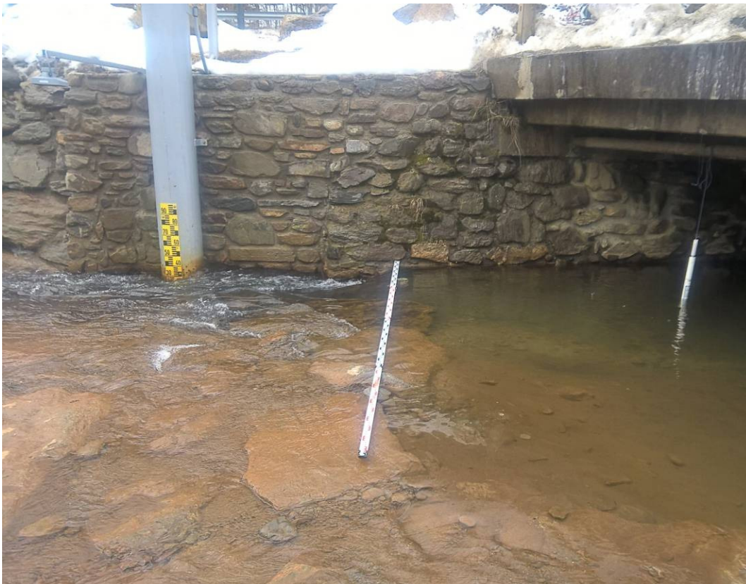
Fig. 25 - Infrastrutturazione della stazione di rilevamento S2 in data 23.02.2016 durante una misurazione delle portate con metodo correntometrico.
