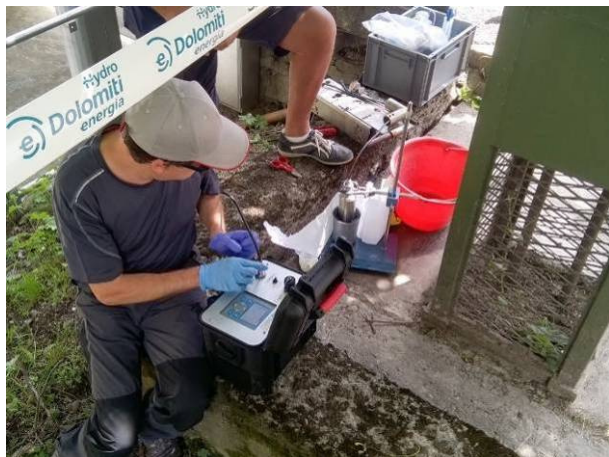
Fig. 1 - Manutenzione straordinaria della stazione S1 - Pont eseguita in data 06.07.2017: 1) estrazione del carrello porta sonde mediante apertura del tubo di protezione 2) fase di ritaratura del turbidimetro mediante immersione in liquido di controllo a torbidità nota.
