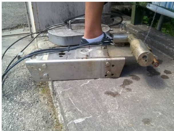
Fig. 1 - Manutenzione straordinaria della stazione S1 - Pont eseguita in data 06.07.2017: 1) estrazione del carrello porta sonde mediante apertura del tubo di protezione 2) fase di ritaratura del turbidimetro mediante immersione in liquido di controllo a torbidità nota.
