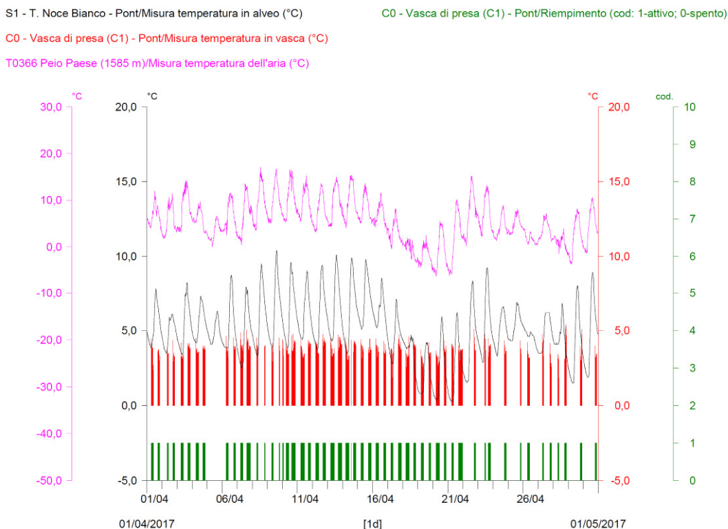
Fig. 89 - Termogrammi comparati C0 vs S1 del mese di APRILE 2017. Si notino la stabilità sui 4 °C delle temperature dell'acqua turbinata, a causa della derivazione di acque dai bacini artificiali, e il forte abbassamento naturale delle temperature in alveo nella seconda metà del mese.
