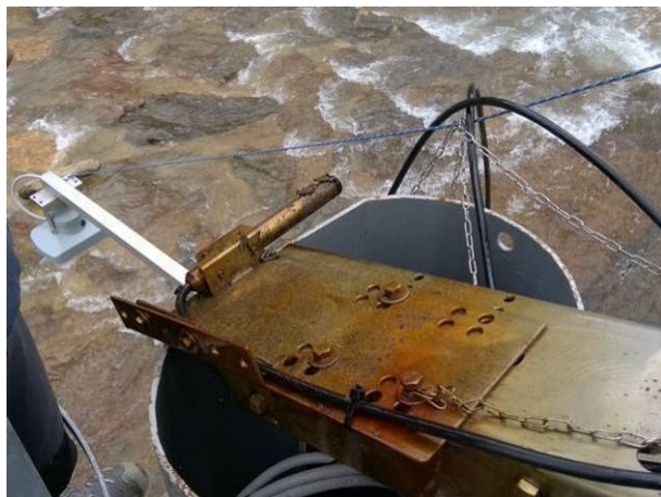
Fig. 2 - Manutenzione straordinaria della stazione S2 - Cogolo - Val del Monte in data 05.07.2017: 1) estrazione del carrello porta sonde previa apertura del tubo di protezione 2) assetto complessivo della stazione vista da valle.
