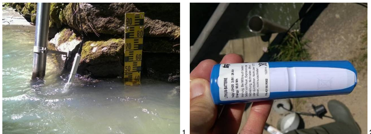
Fig. 4 - Manutenzione straordinaria della stazione S4 - Cusiano eseguita in data 05.07.2017: 1) immersione in alveo della sonda di controllo della temperatura, 2) sostituzione della batteria di alimentazione in quanto la stazione S4 non è dotata di pannello solare.
