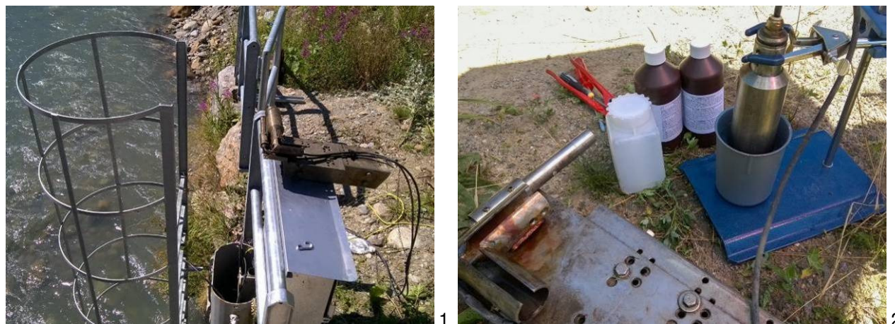
Fig. 3 - Manutenzione straordinaria della stazione S3 - Masi di Contra eseguite in data 06.07.2017: 1) estrazione del carrello porta sonde mediante apertura del tubo di protezione 2) fase di ritaratura del turbidimetro mediante immersione in liquido di controllo a torbidità nota.
